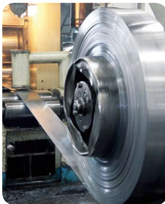
Laminatrice continua per ottenere uniformità di spessore del materiale della lastra
