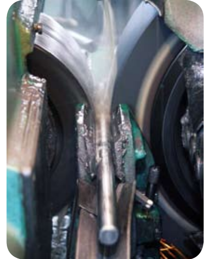
I perni sono rettificati per ottimizzarne la resistenza all'usura.
