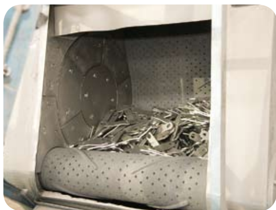
I particolari pallinati migliorano la fatica e la resistenza alle rotture
