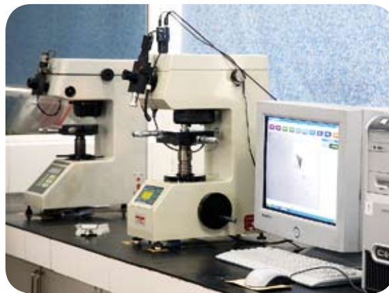
Impianto di test per microdurezza con il quale sono effettuate le verifiche sui lotti per assicurare che la durezza rientri nei valori delle specifiche
