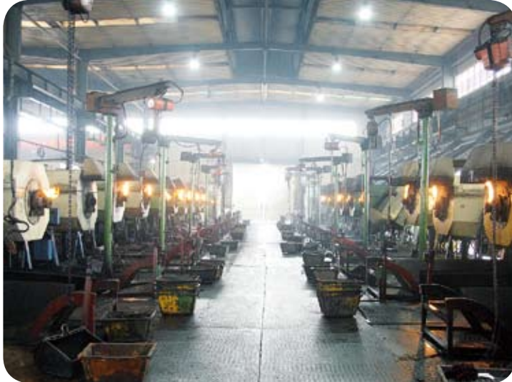
Sono utilizzati forni a rotazione per il trattamento termico dei perni al fine di garantire una dispersione uniforme del calore.
