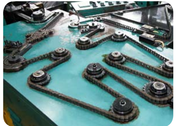
Impianto automatico di assemblaggio catene per garantire che siano rispettati il montaggio e le corrette tolleranze.
