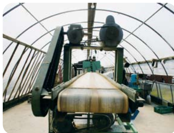
Catene SKF Xtra Performance SRL utilizzate in una macchina di processo degli alimenti
