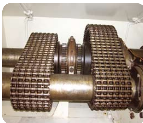
Catena a file multiple per impianti petroliferi utilizzata in una pompa per il fango
